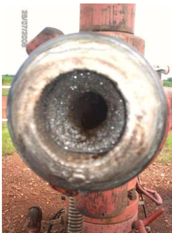
Figura 2 - Incrustação em tubulação de instalação onshore
