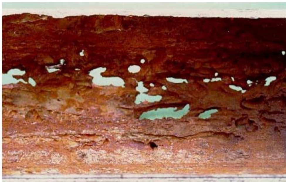
Figura 1 - Tubulação que sofreu corrosão por CO 2
